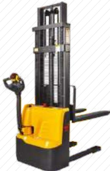
Самоходный полностью электрифицированный штабелер. Бюджетный вариант. Привод на перемещение на поворотное колесо. Все колеса закрыты защитным кожухом, предотвращающим нежелательный контакт двигателя с окружающими предметами. Управление осуществляется через кнопки на рукояти. Тяговый аккумулятор обеспечивает до 8 часов работы в режиме не высокой интенсивности.
