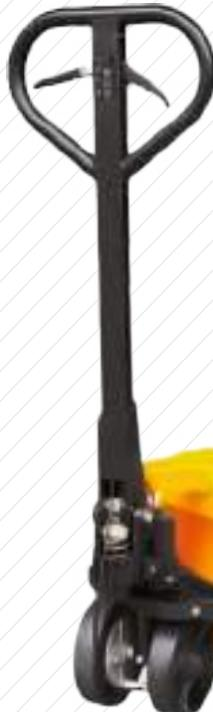
Современная гидравлическая тележка, оснащенная барабанными тормозами на поворотное колесо. Наличие тормозного механизма позволяет притормаживать на спуске и фиксировать колеса, предотвращая откат тележки. Гидроузел литой. Комплектуется колесами и роликами двух типоразмеров, что влияет на характеристики высот подъема-спуска.
